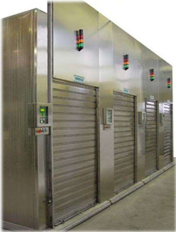
Dopo l'insacco, le mortadelle vengono appese in apposite giostre e portate all'interno di *stufe di cottura* funzionanti ad **85°C** mediante immissione di vapore (*ad aria secca*).
